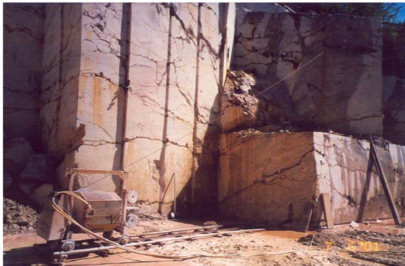
Slika 3.: Diamantna žična žaga pri površinskem pridobivanju.
