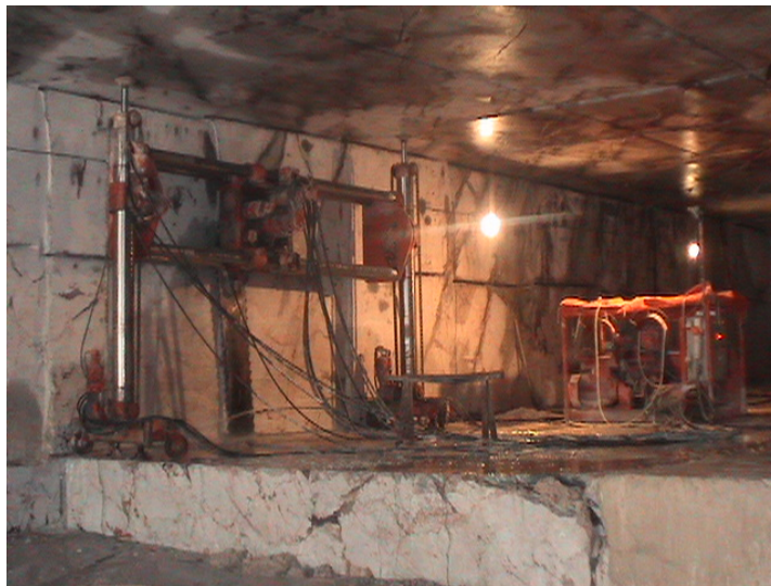
Slika 4.: Zarezovalni verižni stroj Fantini s hidravličnimi stojkami, tip: G-70.
