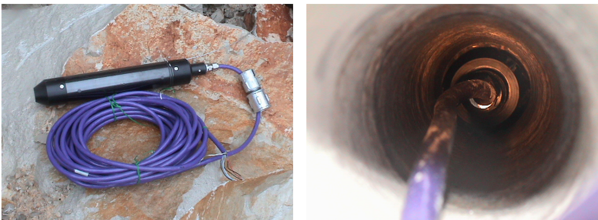
Slika 11., 12.: 2D merilec napetostnega stanja (VW biaxial stressmeter 4350BX) in njegov položaj v vrtini.
