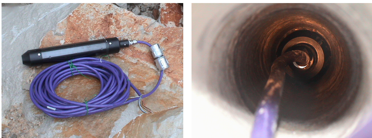
Slika 13., 14.: 2D merilec napetostnega stanja (VW biaxial stressmeter 4350BX) in njegov položaj v vrtini.
