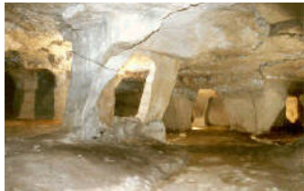
Slika 1., 2.: Podzemno pridobivanje naravnega kamna v kamnolomu Beer [6].
