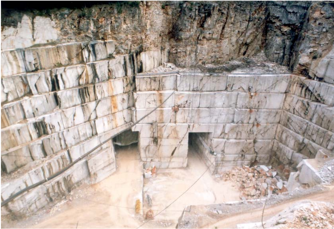
Slika 1.: Klasično pridobivanje blokov naravnega kamna z visokimi etažami, ki že prehaja v podzemnega; kamnolom Lipica II, stanje 2006
