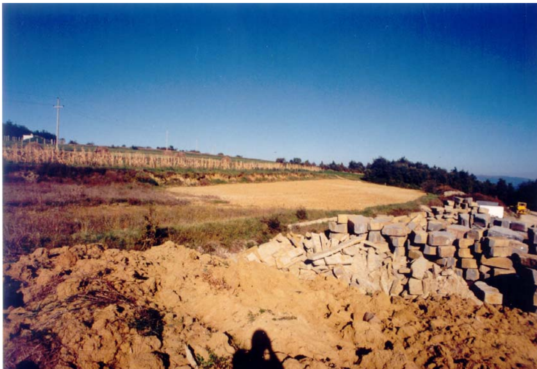
Slika 2.: Pridobivanje s sprotno sanacijo. V ospredju poteka pridobivanje blokov, v ozadju je že sanirana in rekultivirana površina; kamnolom Poljane-Puče, stanje 1995
